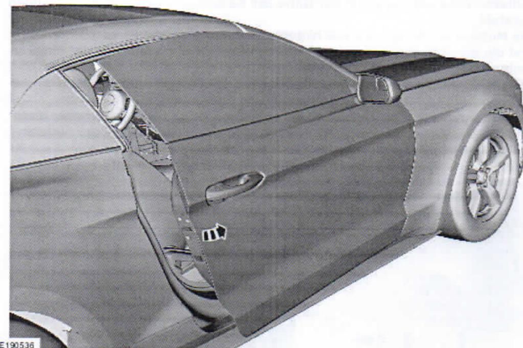
26. Die relative Position der hinteren Seitenscheibe zu den Dichtungen des Faltdachs prüfen. Darauf achten, dass die Stegdichtung vollständig in die Faltdachdichtungen greift, wenn die hintere Seitenscheibe ganz oben steht, und die Türscheibe einwandfrei erfasst.
