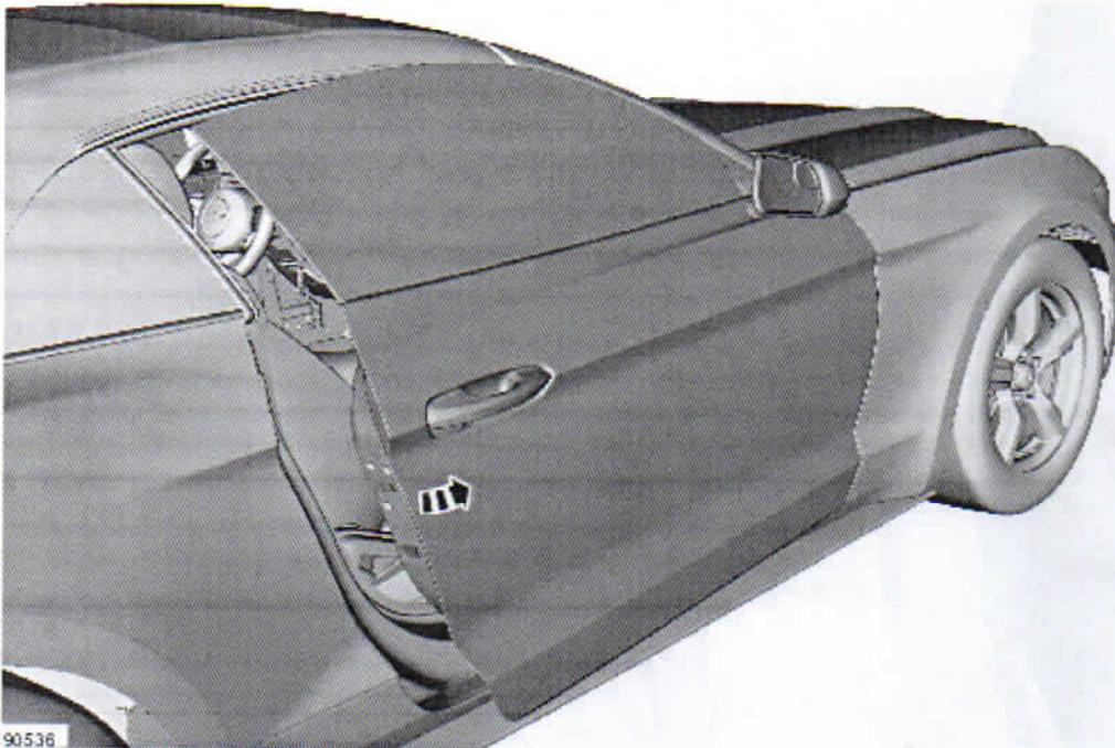
19. Die relative Position der hinteren Seitenscheibe zu den Dichtungen des Faltdachs prüfen. Darauf achten, dass die Stegdichtung vollständig in die Faltdachdichtungen greift, wenn die hintere Seitenscheibe ganz oben steht, und die Türscheibe einwandfrei erfasst.
